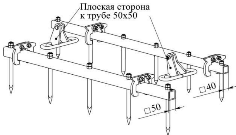
Рис. 4.7.14. Правильная ориентация среднего звена центрального полотна БГУ-Ш.
