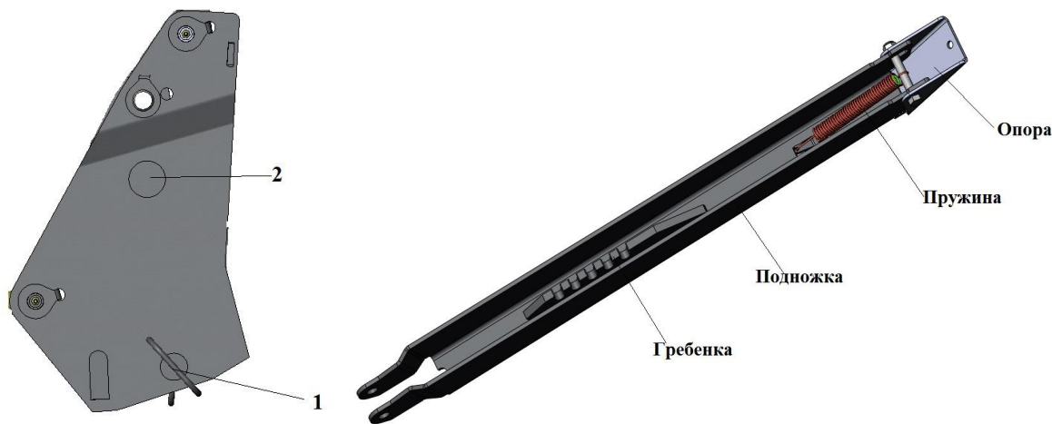
Рисунок 14 – Стойка: 1-фиксатор; 2-бобышка
