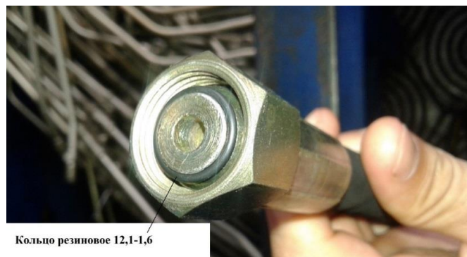
Рисунок 16 – Установка резинового кольца КУН 2000.00.005
