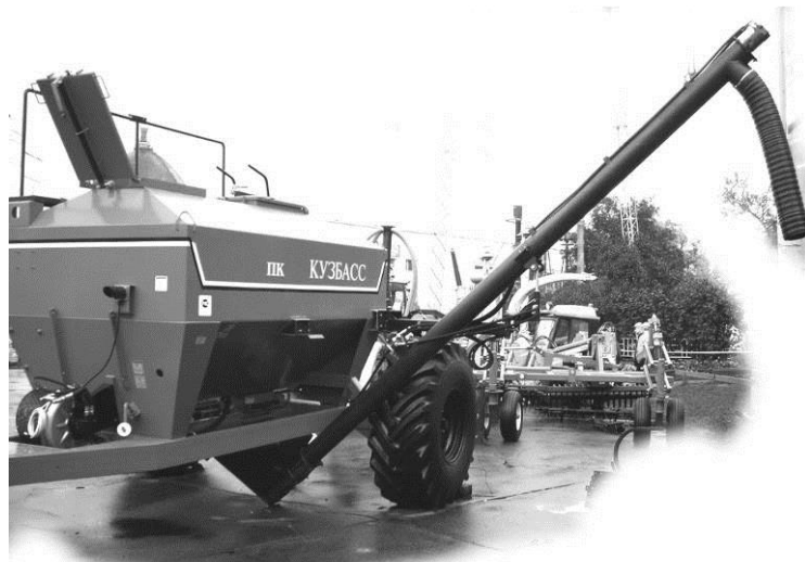
Рис. 6.5.4. Шнек в положении "разгрузка"
