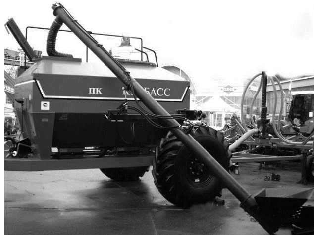
Рис. 6.5.3. Шнек в положении "загрузка"
