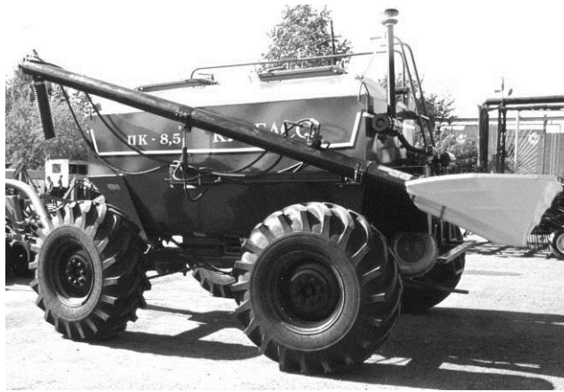
Рис. 6.5.2. Шнек в сборе
