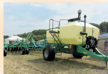
Различные варианты исполнения бункера – двухосный и одноосный – допускают его размещение в составе агрегата как позади посевного орудия, так и непосредственно позади трактора, перед посевным орудием. Во втором варианте повышается нагрузка на заднюю ось трактора, что снижает буксование тягача и увеличивает маневренность комплекса в целом.
