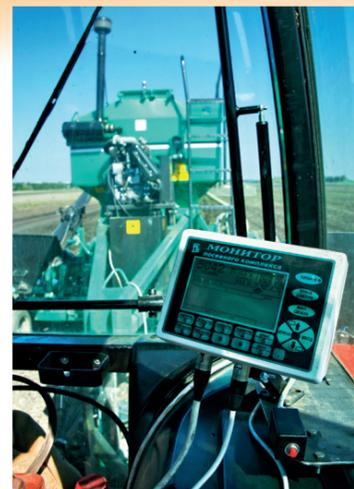
Система контроля засорения семяпроводов и сошников, устанавливаемая на посевной комплекс опционально, позволяет механизатору в процессе работы не только своевременно получать сигнал о засорении отдельных сошников или семяпроводов, но и контролировать общую интенсивность и равномерность сева. Система, кроме того, дает возможность получать информацию о норме высева и контролировать ее.
