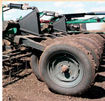
Посевной комплекс «Кузбасс» по выбору заказчика оснащается двумя типами прикатывающих систем: на основе пневматических колес и металлических спиральных шлейф-катков.
