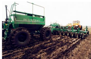
Основными составными частями посевного комплекса являются универсальное почвообрабатывающее посевное орудие и бункер с автономной пневматической высевальной системой.
