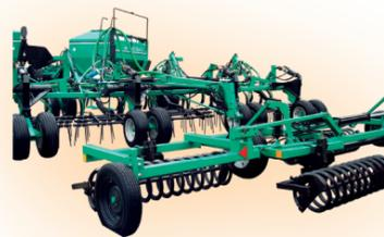
Металлические спиральные шлейф-катки для посевного комплекса «Кузбасс» предлагаются в навесном исполнении или прицепном варианте как самостоятельное орудие (спиральный каток СК). Прицепные катки могут быть установлены как за пневматическим бункером посевного комплекса, так и непосредственно за культиватором, тем самым расширяя диапазон технологических схем построения комбинированных агрегатов на основе ПК «Кузбасс».
