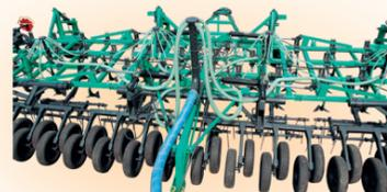
Нагнетательный вентилятор пневматической высевальной системы воздушным потоком через семяпроводы подает семена и удобрения на первичную распределительную головку, а затем – на вторичные, от которых высеваемый материал поступает непосредственно в сошники и попадает в почву. Вентилятор получает привод от автономного дизельного двигателя, установленного на бункере, или от гидравлического мотора, работающего от гидросистемы трактора.
