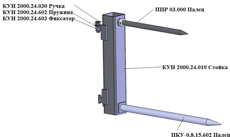
Навеска для тюков (стойка) предназначена для подбора и погрузки тюков и рулонов в транспортные средства. Сама стойка навешивается на рамку КУН 2000.17.010 (поставляется отдельно) и фиксируется фиксатором. Стойку можно переворачивать и крепить любой стороной на рамке меняя крепление фиксатора.
