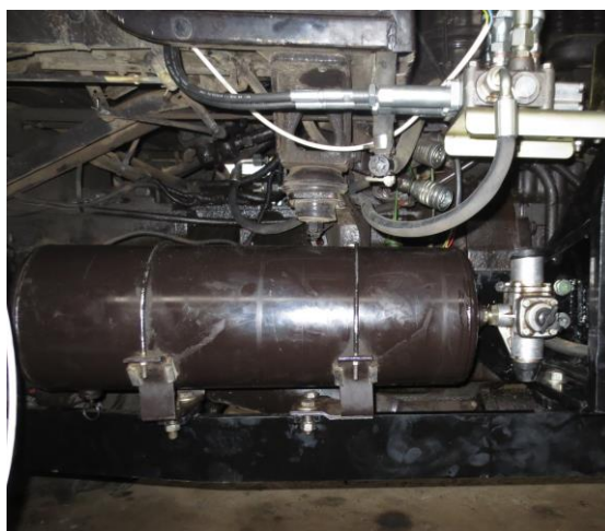
Рисунок 9 – Установка ресивера на КУН-1500 и КУН-2000
