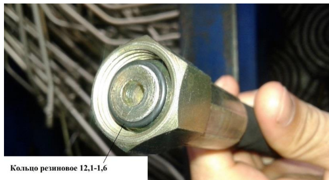
Рисунок 16 – Установка резинового кольца КУН 2000.00.005
