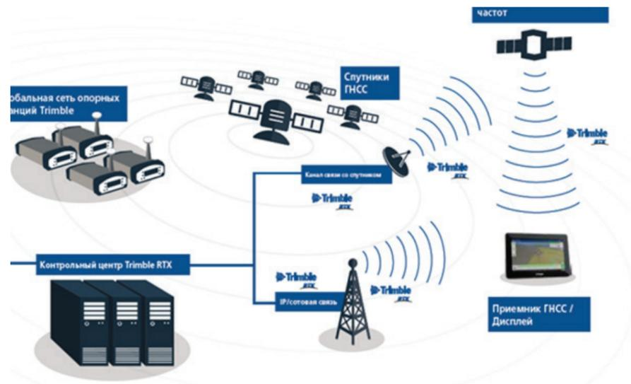
Для формирования поправок Trimble RTX используются спутниковые измерения с глобальной сети станций слежения в реальном времени, а также высокоточные модели атмосферы и специальные алгоритмы. После этого поправки передаются на приемник трактора через ряд геостационарных спутников или через Интернет. Приемник использует эти поправки для повышения стандартной точности ГНСС позиционирования (GPS/ГЛОНАСС/Galileo/Beidou)
